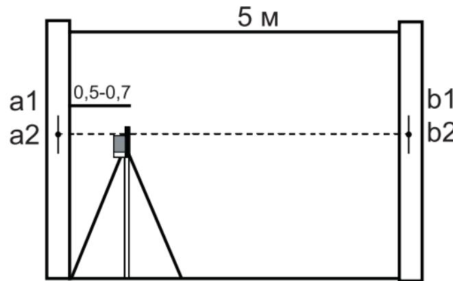
**Проверка точности горизонтального луча (изгиб плоскости)**
