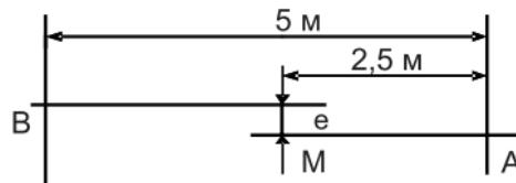
**Проверка точности вертикального луча**
